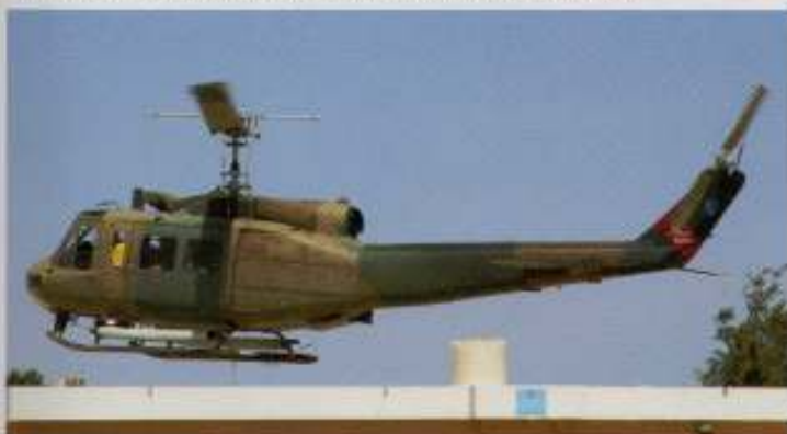
↑軽快なタービン音とローターの徹切の音と共に薄れるAB205A。世界初の實用ガス・タービン・ヘリコプターとして誕生したUH-1Aとその生産バージョンUH-1Bの胴体をストレッチして、エンジンを強化型に換装することで性能向上を図ったUH-1Dは、世界各国に広く販売されてベストセラーとなった。それをアグスタ社がライセンス生産し、アグスタ・ベルとして販売を始めたのが本機で、すでに生産は終了している
