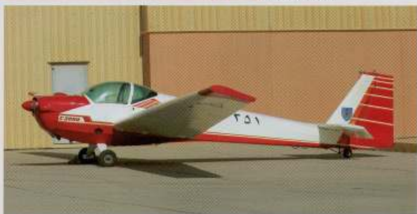
↑アグスタ・ベルAB205Aなどのヘリコプターを運用する第14飛行隊のエンブレム ↓シンガポールとパキスタンという面白い組み合わせで開発されたシーベSF-250モーター・ファルケ。C型はシリーズの中でも最強のエンジンを備えたモーター・グライダーで、オマーンでは2機を購入し第1飛行隊で基礎飛行訓練に用いている
